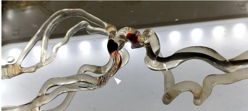
Figura 3. Simulador de colocación de “stent retriever”
